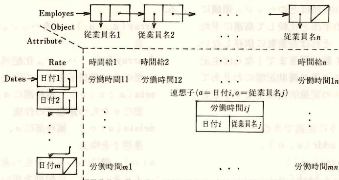
図5 連想子による payroll システムの構成 (破線内が連想子で疎にちらばっている)
